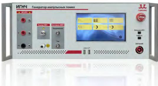
ИГНЧ - это многофункциональный модульный генератор, предназначенный для испытаний технических средств на воздействие микросекундных (МИП) и наносекундных (НИП) импульсных помех, провалов и прерываний напряжения питания переменного или постоянного тока, магнитных полей промышленной частоты (МППЧ), импульсных магнитных полей (ИМП). Управляется через полноцветный емкостный сенсорный экран и имеет встроенное устройство связи/развязки.
